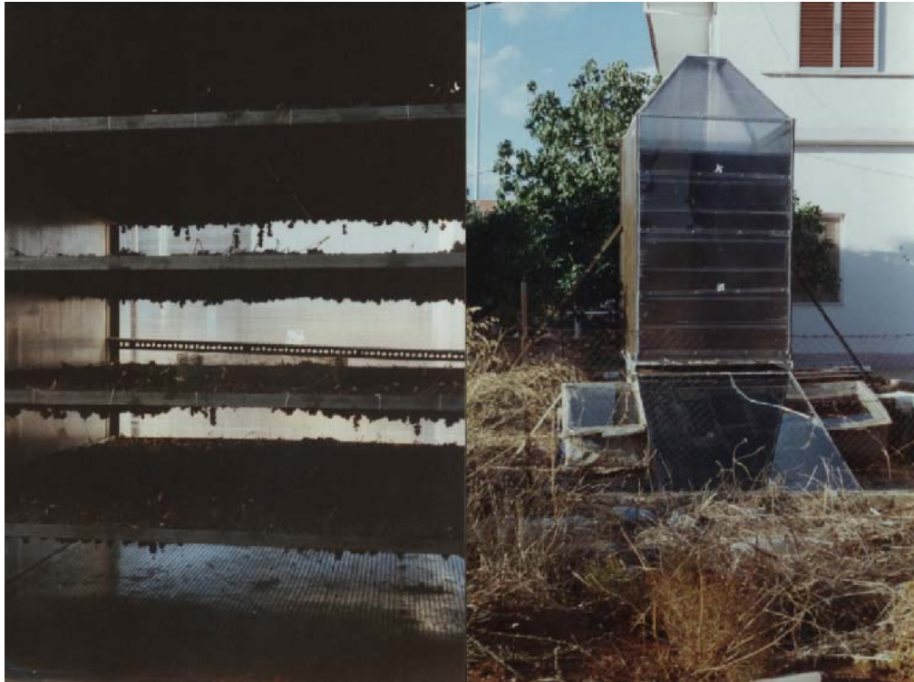
Φ.3.1. (δεξιά) Μεσημβρινή πλευρά του μοντέλου το καλοκαίρι του 2001 και Φ.3.2.(αριστερά) Το εσωτερικό του χώρου ξήρανσης με μερικά από τα 8 ράφια σταφίδας και την διάτρητη λαμαρίνα στο κάτω μέρος, για την ισοκατανομή του αέρα.
